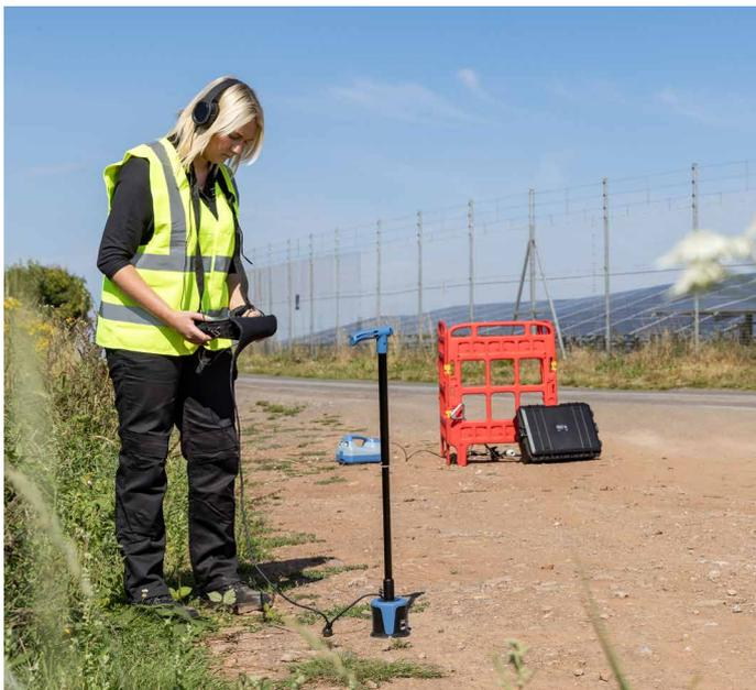
Sistema di rilevazione acustica a alta sensibilità, il RD510 è in grado di rilevare con accuratezza perdite fino a 5 metri
