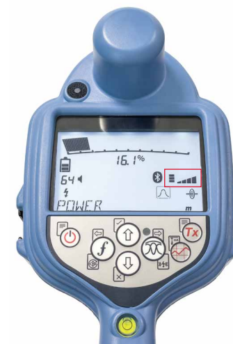
图 1b. 定位仪已识别卫星
