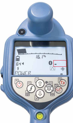
图 1a. 定位仪正在搜索卫星
