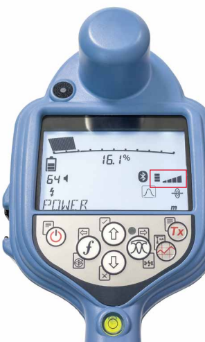
图 1b. 定位仪已识别卫星
