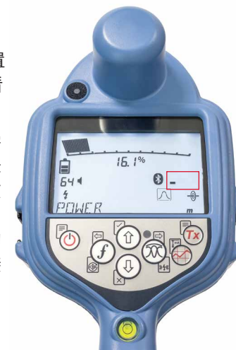
图 1a. 定位仪正在搜索卫星
